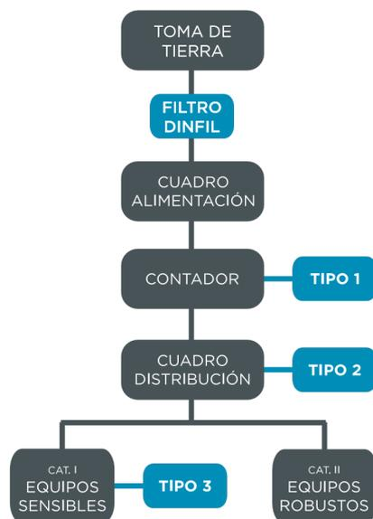
Figura 5. Esquema de la instalación eléctrica.
